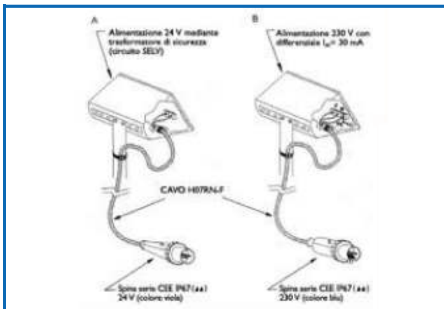
▲ Figura 3 – Apparecchi d'illuminazione trasportabili:
